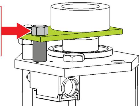
Um den Stößel zu lösen, öffnen Sie die Schraube. (In *Abbildung 3* GRAU)
