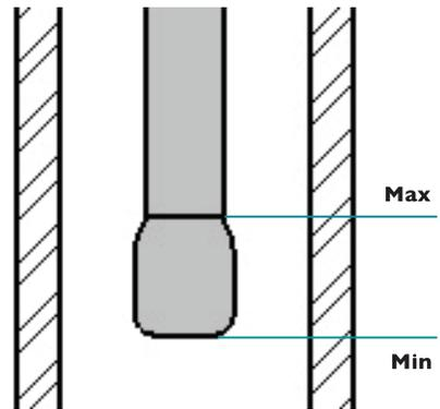
Das Öl muss im korrekten Betriebsbereich sein, damit der Puffer ordnungsgemäß funktioniert. Wird nach der Überprüfung weiteres Öl benötigt, wiederholen Sie die Schritte 3-7.
